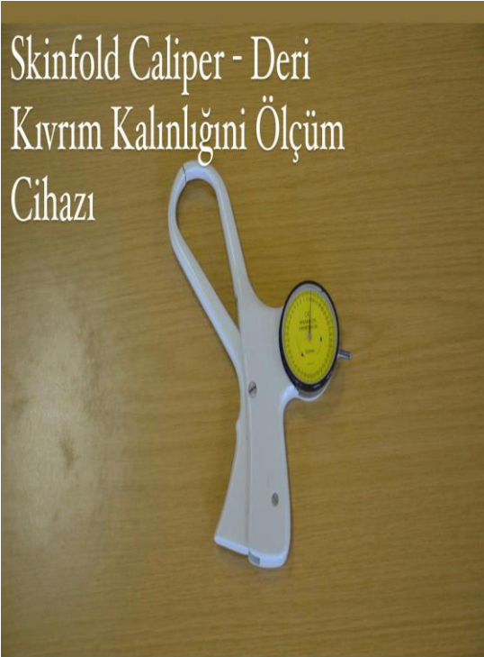
Resim 21: Skinfold Caliper-Deri Kıvrım Kalınlığı Ölçüm Cihazı
