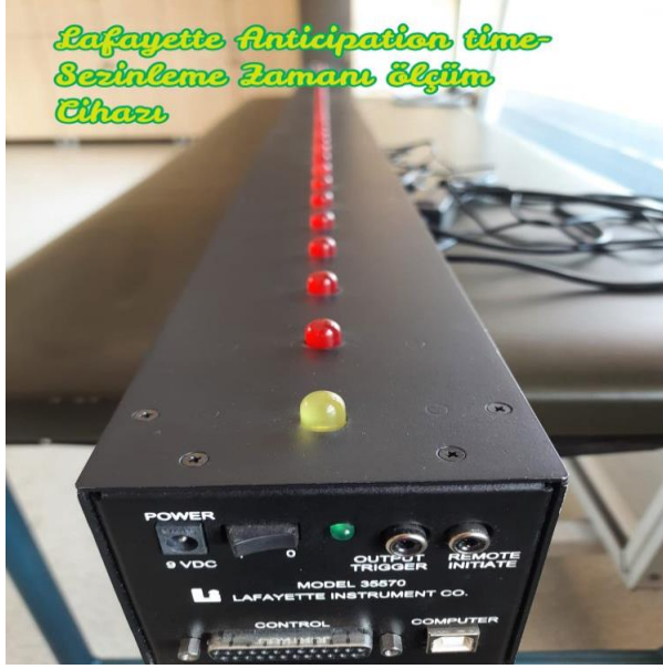
Resim 19: Lafayette Anticipation Time- Sezinleme Zamanı Ölçüm Cihazı
