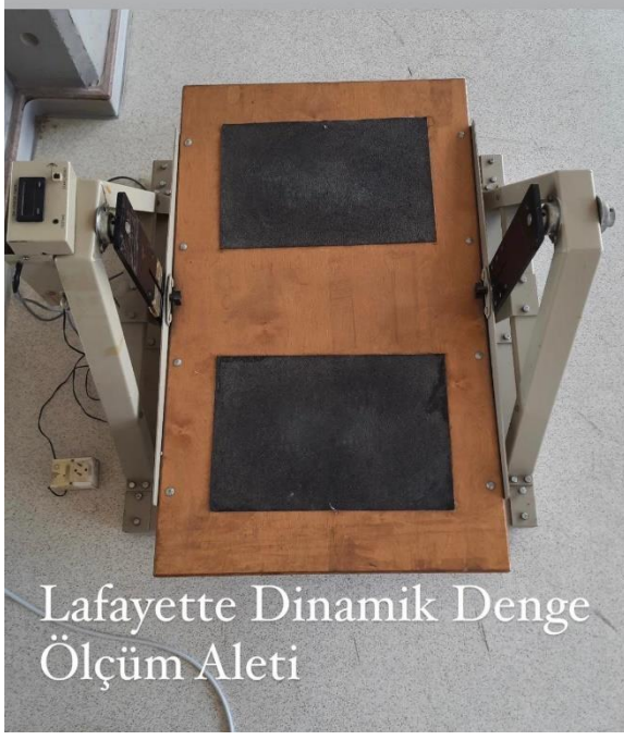
Resim 9: Lafayette Dinamik Denge Ölçüm Aleti
