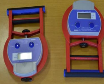
Takei Marka El Kavrama Kuvveti Ölçüm Dinamometresi
