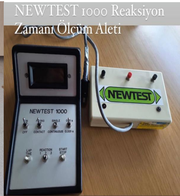
Resim 14: Newtest 1000 Reaksiyon Zamanı Ölçüm Aleti
