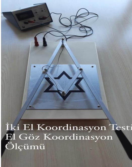
Resim 3: İki El Koordinasyon Testi Ölçüm Cihazı
